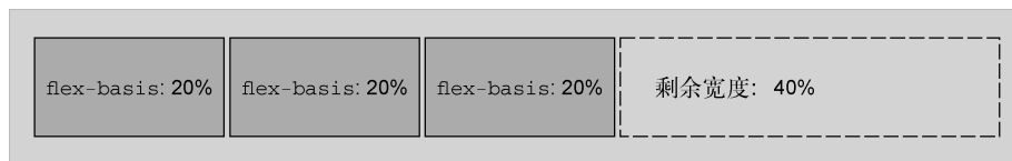
图 5-8 三个弹性子元素的弹性基准是 20%，每一个元素初始主尺寸（宽度）为 20%
