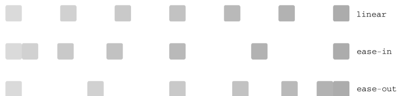
图 14-3 linear 过渡以恒定的速度移动，而 ease-in 加速， ease-out 减速
